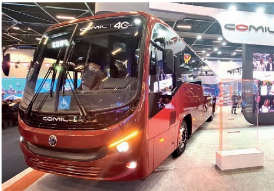
Carroceria Versatile V4 oferece maior espaço interno, graças a largura ampliada de 2,60 m
