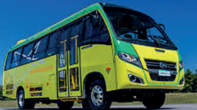
Microônibus Volare na versão híbrida: combinação de motor elétrico e a etanol
