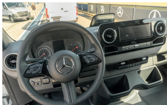
Transmissão pode ser acionada por alavanca atrás do volante ou borboletas na direção
