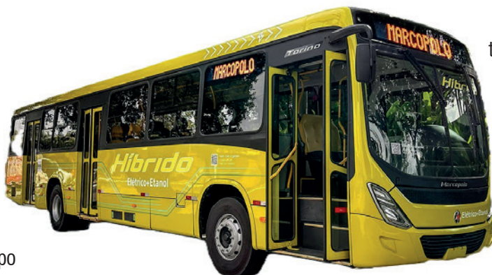
Ônibus urbano híbrido elétrico/etanol da Marcopolo: emissão zero de Carbono
