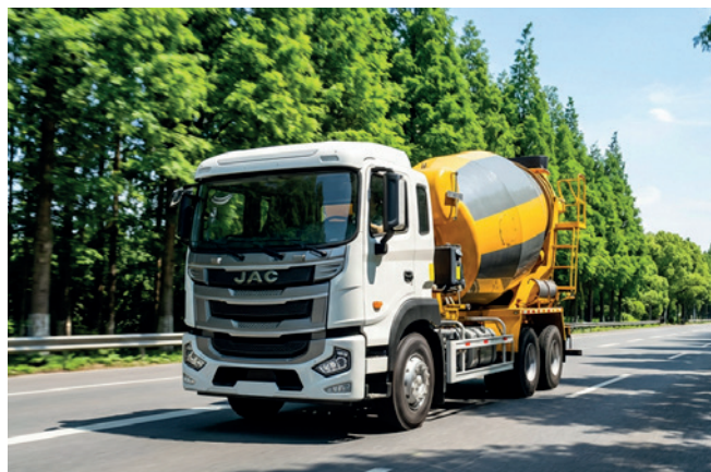
JAC A 25.290: tração 6x4 e PBT Técnico de 23t
