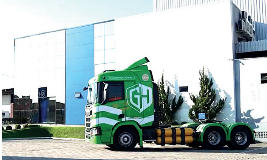
Tanques suplementares na frota à gás aumentaram em 50% a autonomia dos veículos
