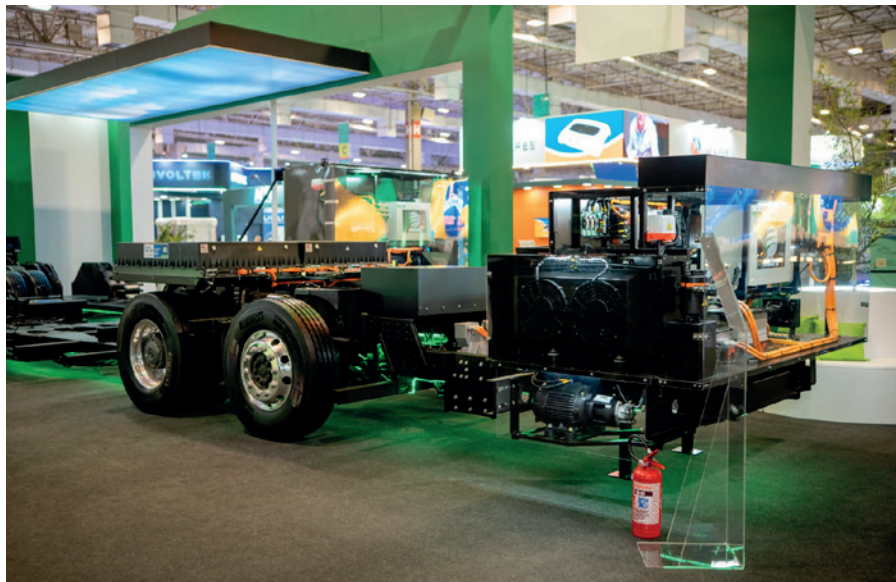
Todos os chassis são de piso baixo com autonomia entre 250 a 350 Km
