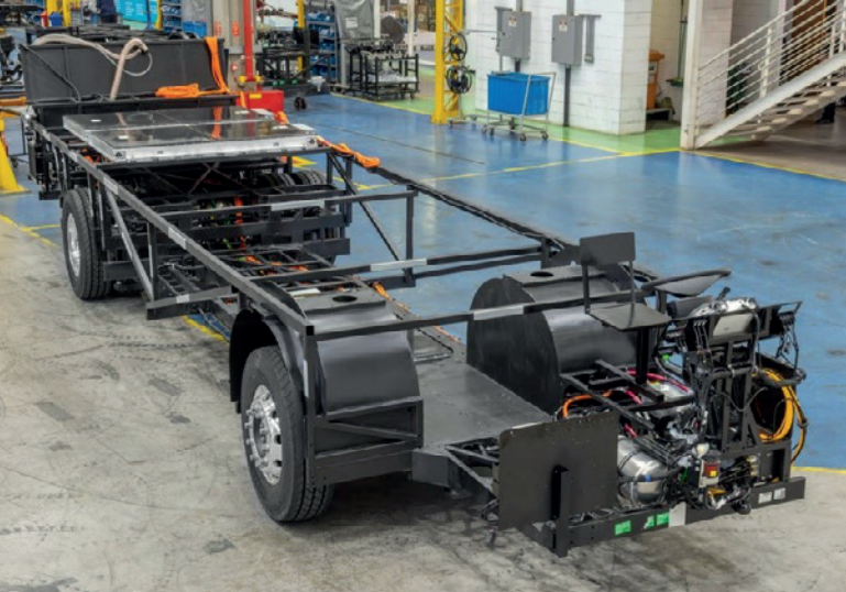
Adoção da bateria Blade reduziu tara do veículo em 1,5 tonelada
