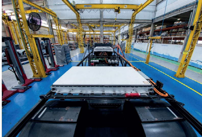
Adoção da bateria Blade reduziu tara do veículo em 1,5 tonelada
