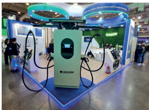
Dener Andrade o carregador DC de 180 kW: desenvolvido a partir da experiência prática em garagens
