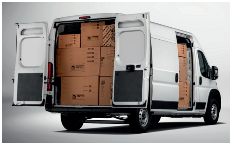
Porta traseira com abertura de 270° e lateral deslizante facilitam a carga e descarga
